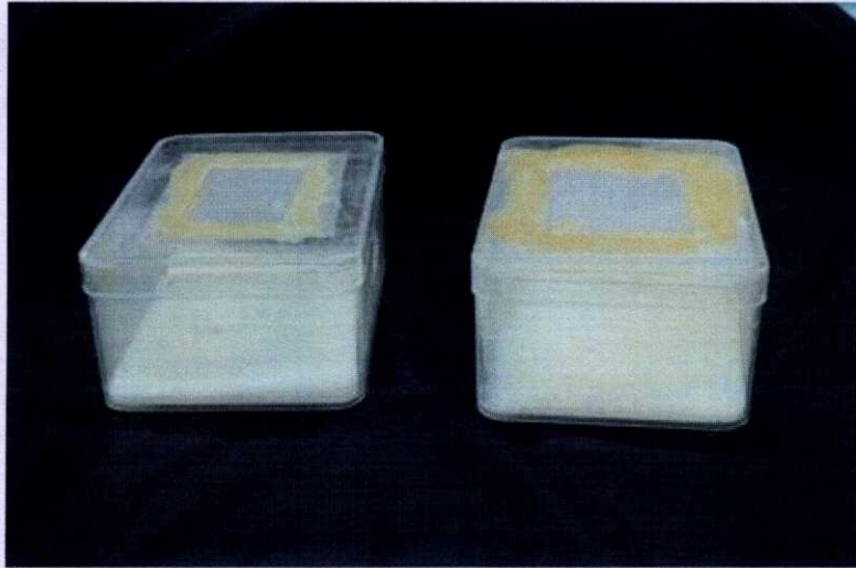
ภาพที่ 3.6 กล่องสำหรับเลี้ยงแมลง ขนาด 6 \times 9.7 \times 3.6 cm สำหรับทดสอบประสิทธิภาพสารการยับยั้งการวางไข่
