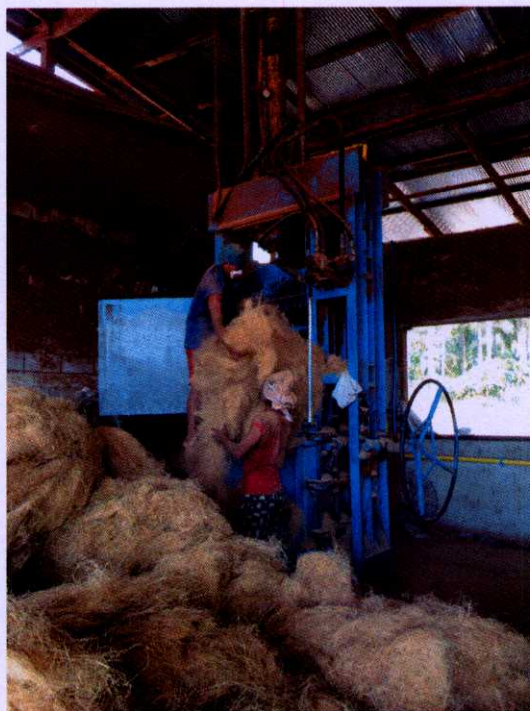
ภาพ การนำเส้นใยป้อนเข้าสู่ตู้อัดไฮโดรลิก
