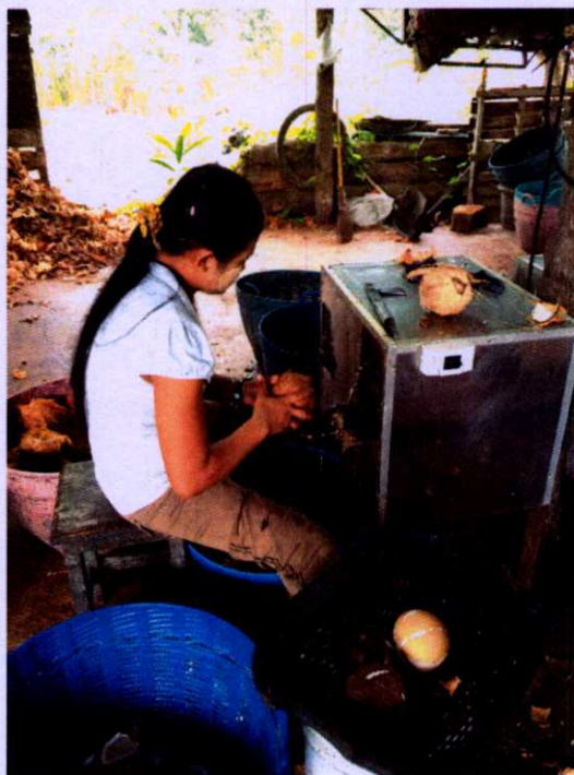
ภาพ การใช้เครื่องแยกกะลา และเนื้อออกจากกัน
