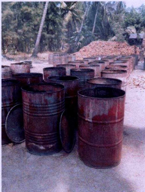
ภาพ ถัง และฝาถัง ที่ใช้ในการเผากะลา
