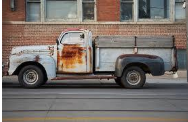
รูปที่ 2.2 รถยนต์ที่เกิดการกัดกร่อนบนผิวเหล็กที่อยู่ภายใต้สีเคลือบที่หลุดร่อน
