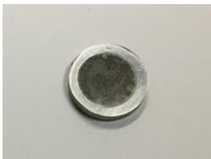
รูปที่ 4.4 เหล็กกล้าไร้สนิมชนิด AISI 420 ที่เตรียมจาก produced water จำลองที่มีความเข้มข้นของ NaCl เป็น 3.5% โดยน้ำหนัก
