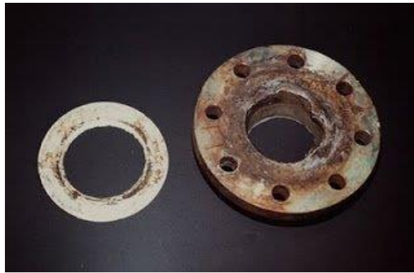
รูปที่ 2.5 ตัวอย่างการกัดกร่อนในที่อับ
