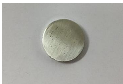
รูปที่ 4.9 เหล็กกล้าไร้สนิมชนิด AISI 304 ที่เตรียมจากเทคนิคโพเทนชิโอสแตติกโพลาไรเซชัน
