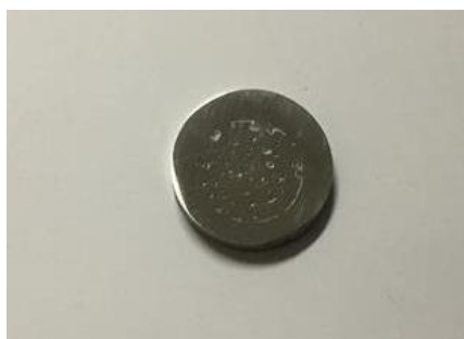
รูปที่ 4.3 เหล็กกล้าไร้สนิมชนิด AISI 420 ที่เตรียมจาก produced water จำลองที่มีความเข้มข้นของ NaCl เป็น 0.095% โดยน้ำหนัก
