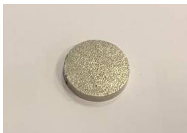
รูปที่ 3.2 สแตนเลสชนิด AISI 304 รูปทรงกระบอก
