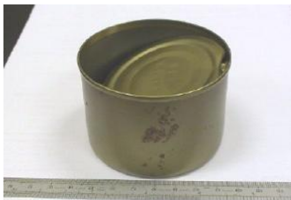
รูปที่ 2.8 การกัดกร่อนใต้ชั้นเคลือบแล็กเกอร์
