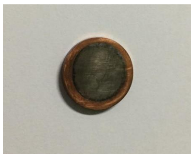
รูปที่ 4.15 โลหะผสม Co-Fe ที่สัดส่วนเชิงมวลของ Co ต่อ Fe เป็น 80:20 ซึ่งเตรียมจากเทคนิคโพเทนชิโอสแตติกโพลาริเซชัน
