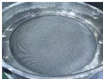
รูปที่ค.2.2 ถอดชั้นตะแกรงร่อนออกจากเครื่อง
