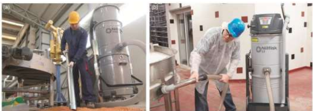
รูปที่ 2.6 ลักษณะเครื่องดูดฝุ่นแบบเคลื่อนย้ายได้ (Transportable vacuum system) ที่มา : Moerman and Mager (2016)
