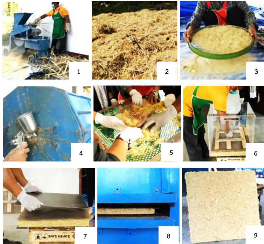
ภาพที่ 2.10 ขั้นตอนการทำแผ่นไม้อัดจากเศษไม้ไผ่
