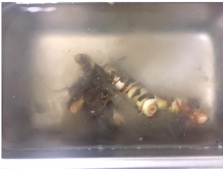
ภาพที่ 3 ขณะทำการล้างในเครื่องอัลตราโซนิกส์
