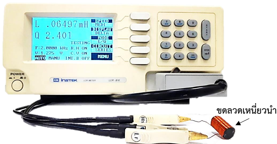
รูปที่ 3.7 การวัดค่าความต้านทานและค่าความเหนี่ยวนำด้วยเครื่องมือวัดแอลซีอาร์ รุ่น LCR-816
