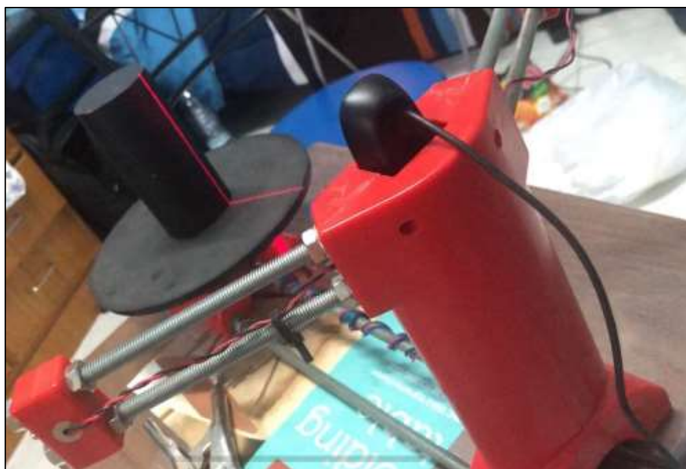
รูปที่ 3.11 ตัวอย่างการสแกนวัตถุทรงกระบอกด้วยเครื่องสแกน Ciclop
