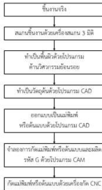
รูปที่ 2.15 ขั้นตอนการทำวิศวกรรมย้อนกลับด้วยเทคโนโลยีสแกนเนอร์ 3 มิติ [9]
