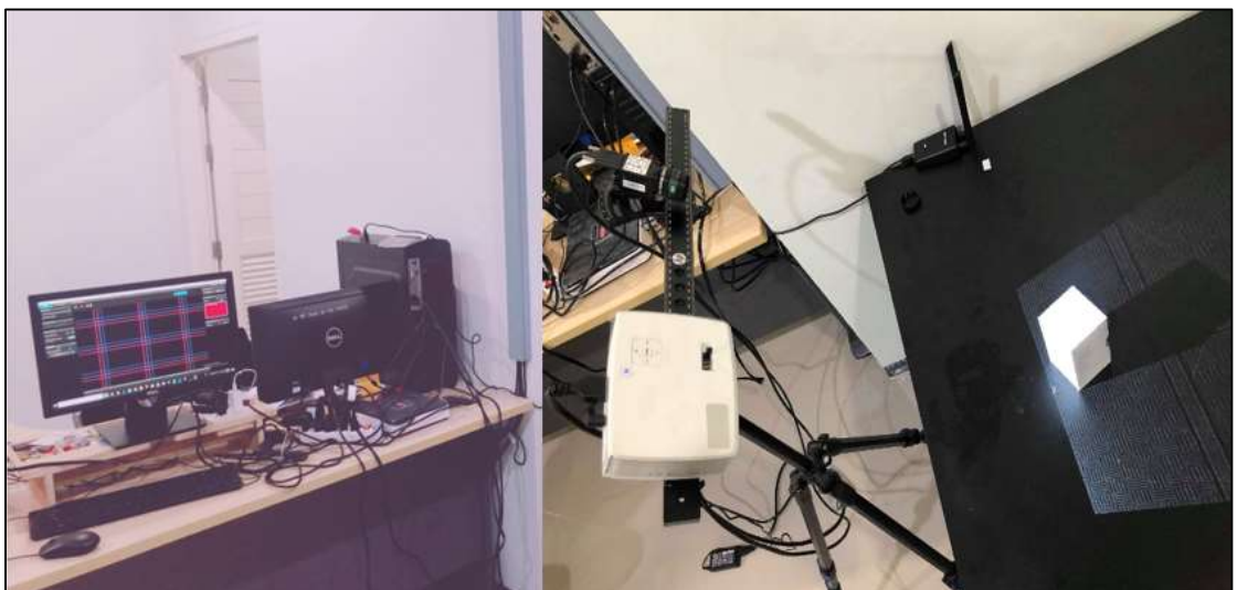
รูปที่ 3.21 ตัวอย่างการสแกนวัตถุทรงกระบอกด้วยเครื่อง DAVID Laser Scanner
