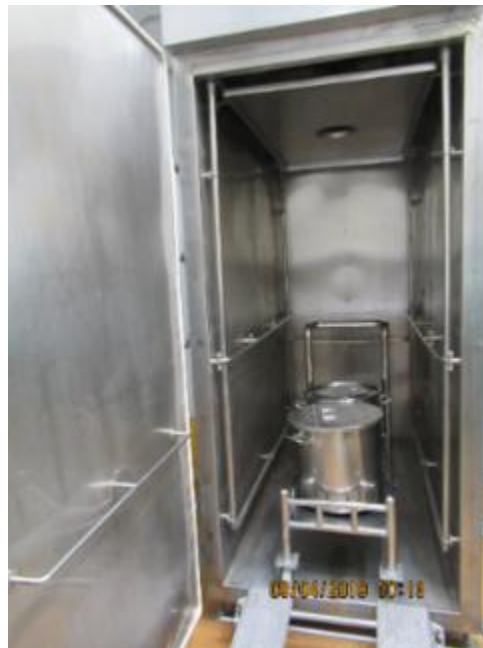
ภาพที่ 4.8 การฆ่าเชื้อรถเข็น โดยการใช้ไอน้ำจากตู้นึ่งไอน้ำ (box steamer)
