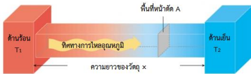
รูปที่ 2.4 แสดงทิศทางการไหลของอุณหภูมิจากด้านที่มีอุณหภูมิสูงไปยังด้านที่มีอุณหภูมิต่ำตามกฎของฟูเรียร์
