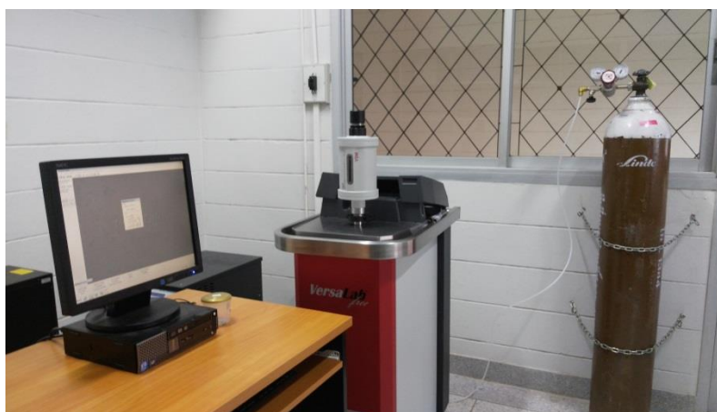
รูปที่ 2.35 แสดงเครื่องวัดความหนาแน่นของพาหะและสภาพการนำไฟฟ้า
