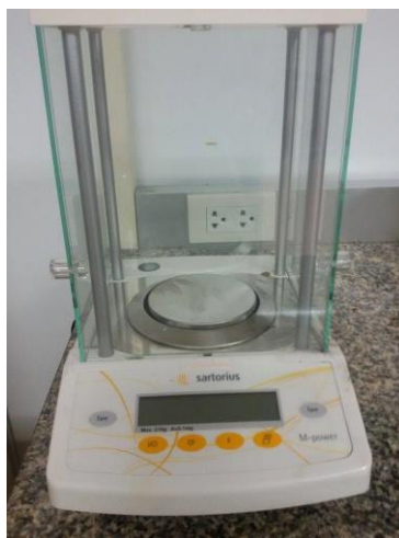
รูปที่ 3.9 แสดงเครื่องชั่งทศนิยม 4 ตำแหน่ง จากบริษัท Sartorius รุ่น AZ Series
