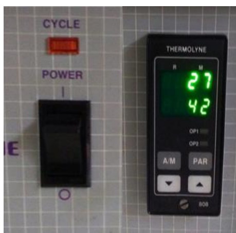
รูปที่ 3.2 แสดงปุ่มเปิด/ปิด เตาเผา และไฟแสดงผล
