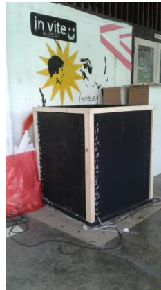
ภาพที่ 3.30 เสริมโครงไม้เพิ่มความแข็งแรงของตัวงาน ด้วยการตีโครงไม้จ๊อยท์ อัดเพิ่มเข้าไปอีกชั้นเพื่อยึดให้ โครงสร้างกล่องแน่นขึ้นไม่ขยับเคลื่อนไปมา
