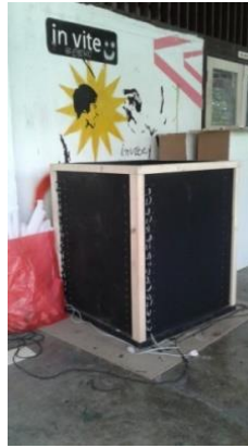
ภาพที่ 3.21 ทาสีดำภายนอกและตีโครงไม้เสริมความแข็งแรง
