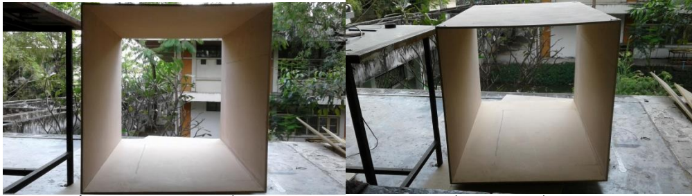
ภาพที่ 3.23 ภาพของกล่องที่วัดมุมไม่ได้องศาทำให้เกิดการเหลื่อมของวัสดุที่นำมาใช้ภายใน
