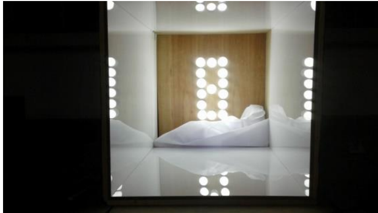
ภาพที่ 3.24 รอยประกบที่ไม่สนิทของอะครีลิกภายในทำให้ดูไม่เรียบร้อย
