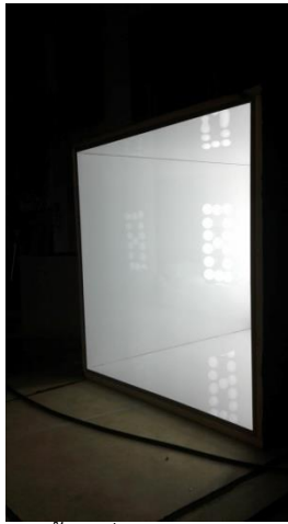
ภาพที่ 3.26 ภาพการทดลองติดตั้งในที่มืด แสงจากตัวงานจะเด่นชัดกว่ากำแพงสีขาว
