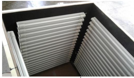
ภาพที่ 3.29 หลอดไฟ T8 ขนาด 60 ซม. ที่นำมาใช้แทน หลอด LED Biobulb
