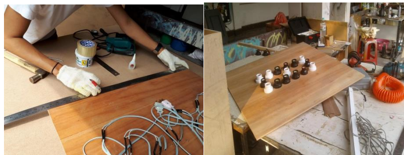
ภาพที่ 3.16 การทำแผงไฟและการเดินสายไฟ
