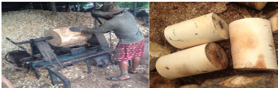
ภาพที่ 4.1 การปอกเปลือกท่อนไม้มะม่วง
