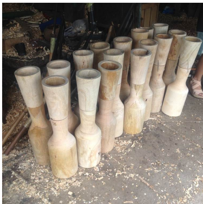
ภาพที่ 2.13 ลักษณะผลิตภัณฑ์หลังการกลึงชิ้นรูป โดย : นฤมล ไทรงาม (ถ่ายเมื่อ 14 สิงหาคม พ.ศ.2557)
