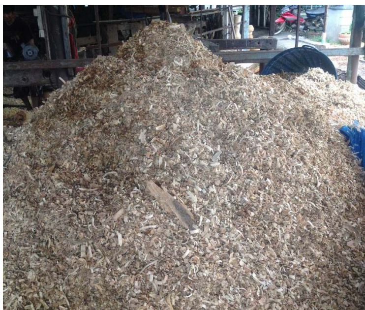
ภาพที่ 2.15 ลักษณะเศษไม้ขนาดเล็กจากการกลิ้งขึ้นรูป โดย : นฤมล ไทรงาม (ถ่ายเมื่อ 14 สิงหาคม พ.ศ.2557)
