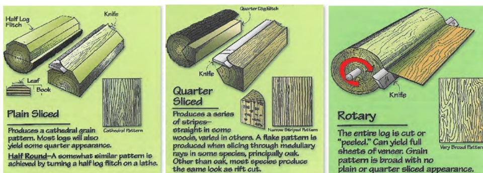
ภาพที่ 2.3 วิธีการแปรรูปไม้จากท่อนซุง ได้แก่การเลื่อย การปอก และการผ่า ที่มา : Hooddistribution, Resource , เข้าถึงเมื่อ 31 พฤษภาคม 2556
