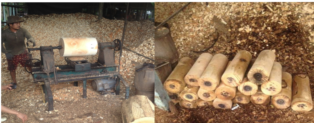
ภาพที่ 4.2 ลักษณะท่อนไม้ที่กลึงเรียบร้อยเตรียมสำหรับการกลึงขึ้นรูป โดย : นฤมล ไทรงาม (ถ่ายเมื่อ 14 สิงหาคม พ.ศ.2557)
