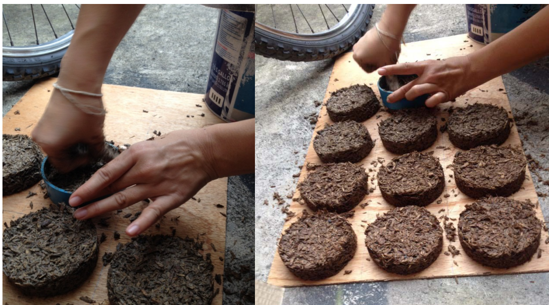
ภาพที่ 2.23 การอัดขึ้นรูปจากแม่พิมพ์ โดย : นฤมล ไทรงาม (ถ่ายเมื่อ 14 สิงหาคม พ.ศ.2557)
