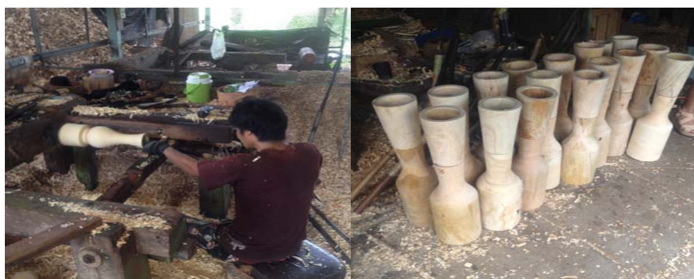
ภาพที่ 4.3 ลักษณะผลิตภัณฑ์หลังการกลึงขึ้นรูป โดย : นฤมล ไทรงาม (ถ่ายเมื่อ 14 สิงหาคม พ.ศ.2557)
