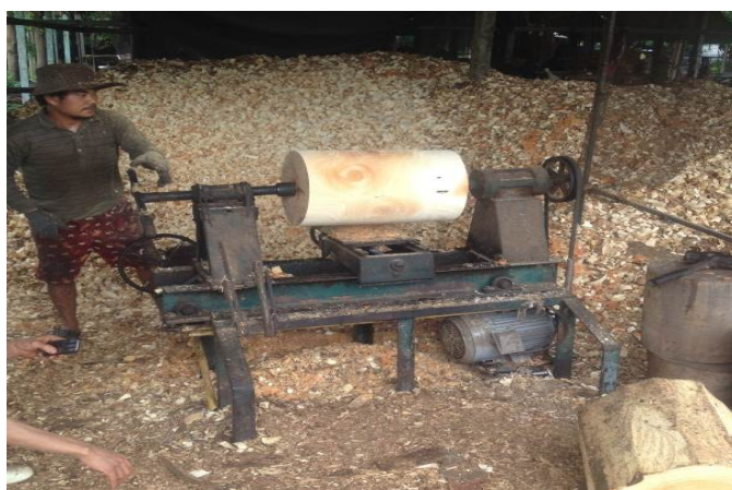
ภาพที่ 2.9 การกลึงลดขนาดท่อนไม้สำหรับเตรียมขึ้นรูป
