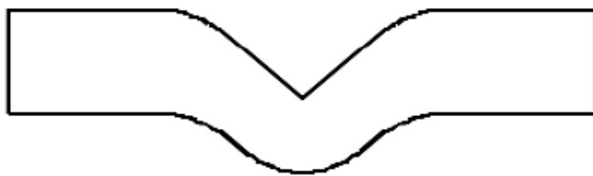
ภาพที่ 3.3 ตัวอย่างชิ้นงานทดสอบค่าความแข็งแรงลึกขาดแบบ Die C [43]
