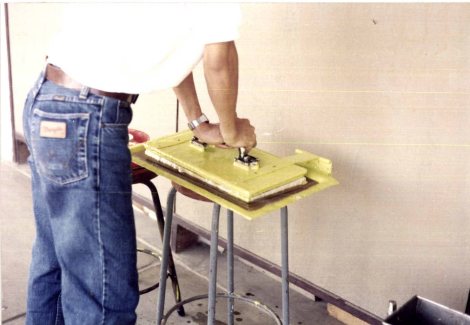
ภาพที่ 6 ขั้นตอนที่ 4 จับฝาปิดด้านบนกดลงกับแม่พิมพ์ด้านล่างสักครู่หนึ่ง
