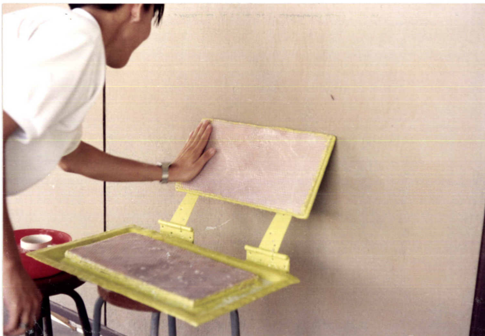
ภาพที่ 4 ขั้นตอนที่ 2 ใช้มอลบน้ำสบูให้ทั่วแม่พิมพ์ทั้งด้านล่างและด้านบน แล้วเทน้ำสบู่ที่เหลือกลับคืน
