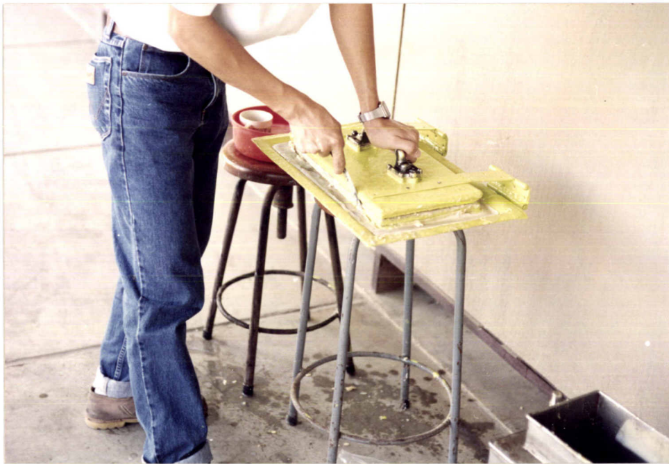
ภาพที่ 8 ขั้นตอนที่ 6 ใช้มีดปาดขอบทั้ง 4 ด้านของแม่พิมพ์ เพื่อให้ไขผึ้งที่ล้นออกจากขอบแม่พิมพ์จะไต่ไม่ติดกับแผ่นรังเทียม
