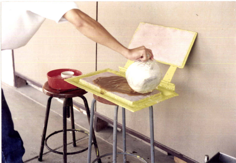
ภาพที่ 5 ขั้นตอนที่ 3 ทำการเทไขผึ้งลงบนแม่พิมพ์ด้านล่าง
