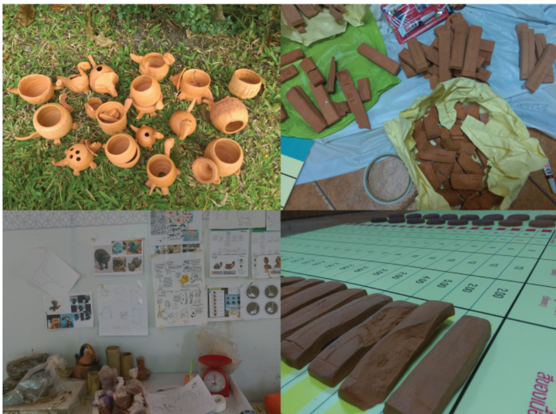
ภาพที่ ข.7 ทดลอง การผสมดินสองชนิดเข้าด้วยกันในระบบไลน์เบนด์ (Line Blend) ที่มา : ธนารักษ์ ทาปลัดถ่ายเมื่อวันที่ 19 มกราคม 2560
