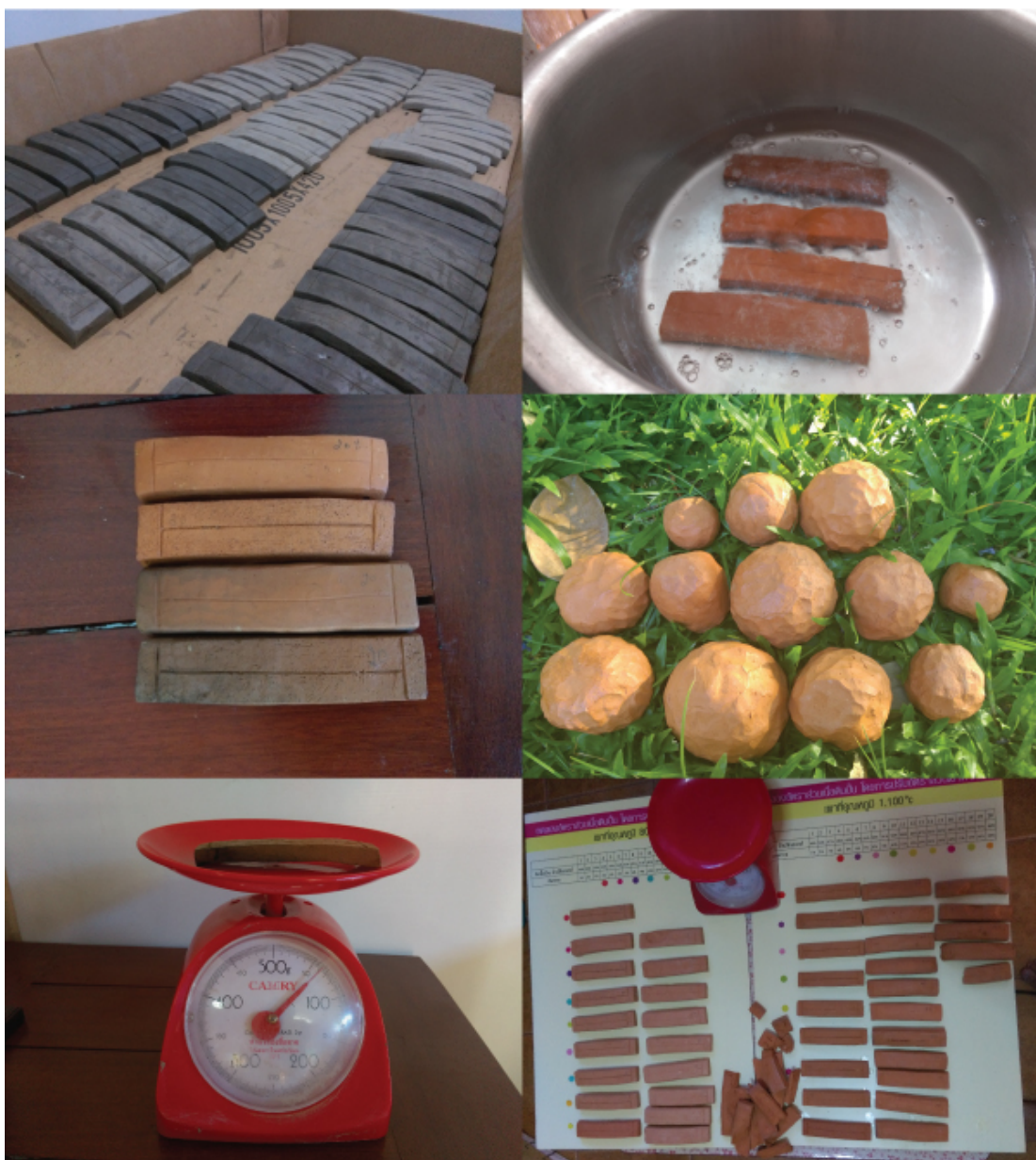
ภาพที่ ข.7 ทดลอง การผสมดินสองชนิดเข้าด้วยกันในระบบไลน์เบนด์ (Line Blend) ที่มา : ธนารักษ์ ทาบลดถ่ายเมื่อวันที่ 15 พฤศจิกายน 2559
