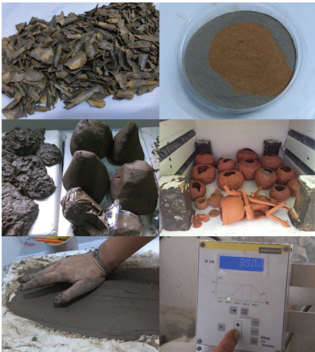
ภาพที่ ข.6 ทดลอง การผสมดินสองชนิดเข้าด้วยกันในระบบไลน์เบนด์ (Line Blend) ที่มา : ธนารักษ์ ตาบลดถ่ายเมื่อวันที่ 9 กันยายน 2559
