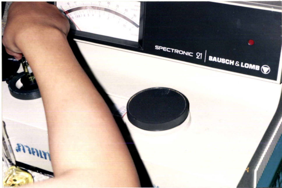
ภาพที่ 29 แสดงเครื่องมือที่ใช้วัดค่าร้อยละของฟอสฟอรัสในการวิเคราะห์ตัวอย่างพืช
