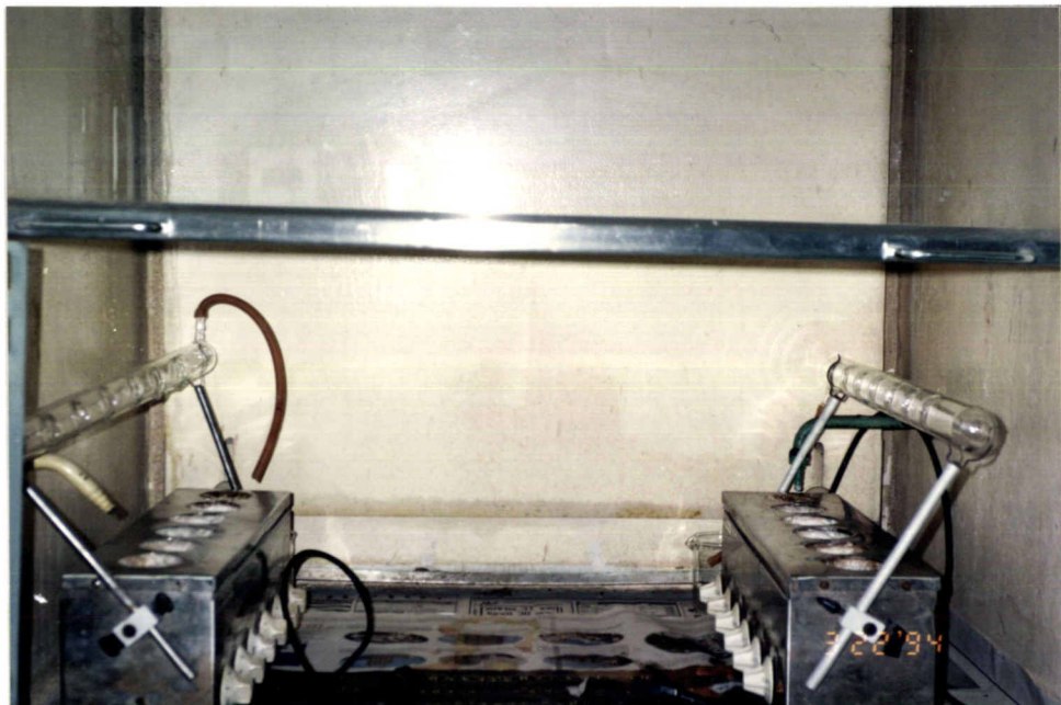
ภาพที่ 30 แสดงเครื่องมือในการ Digest ตัวอย่างพืชเพื่อใช้ในการวิเคราะห์หาไนโตรเจนและฟอสฟอรัส
