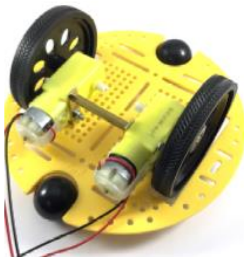
ภาพที่ 2 การติดตั้งมอเตอร์ เข้ากับ ฐานของหุ่นยนต์
