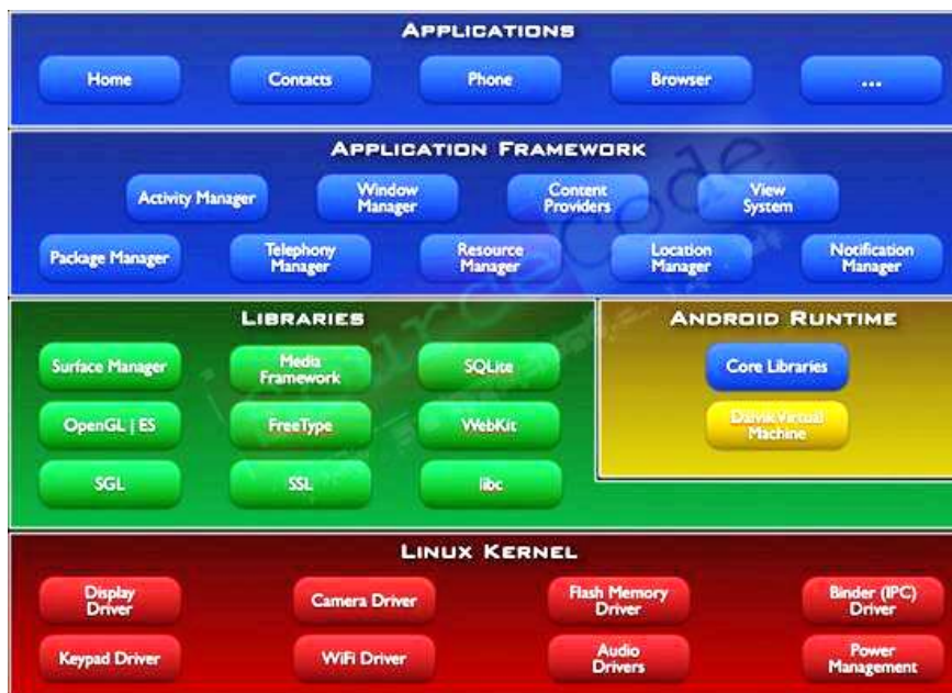
ภาพที่ 2.2 แสดงโครงสร้างของระบบปฏิบัติการแอนดรอยด์
