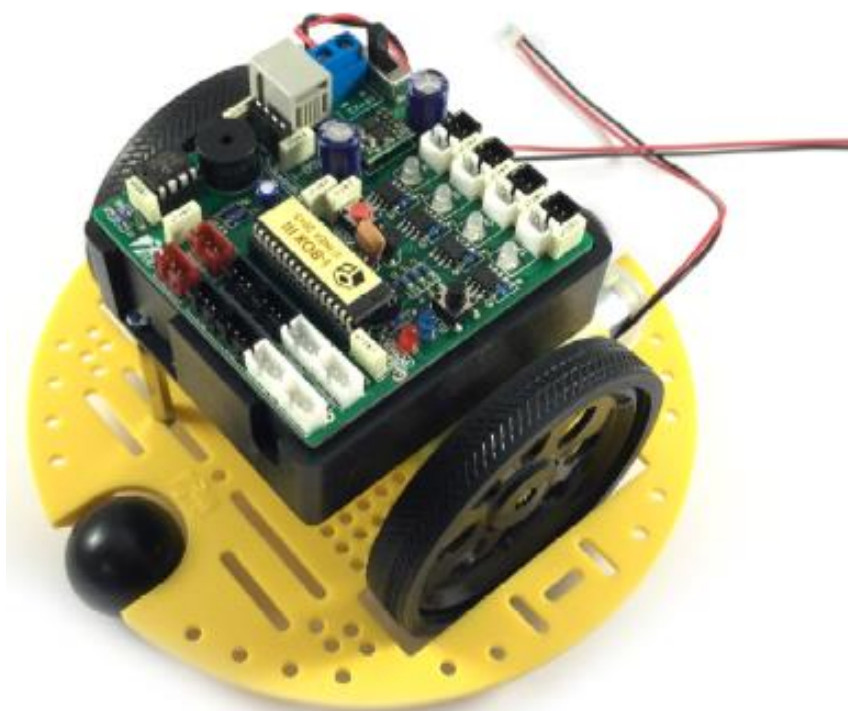
ภาพที่ 3 การติดตั้งแผงวงจรกระบบเข้ากับฐานของหุ่นยนต์
