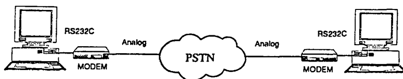
รูปที่ 4.1 โมเด็มช่วยให้คอมพิวเตอร์รับส่งข้อมูลผ่านสายโทรศัพท์ได้ โดยเปลี่ยนสัญญาณให้เป็นเสียงก่อน
