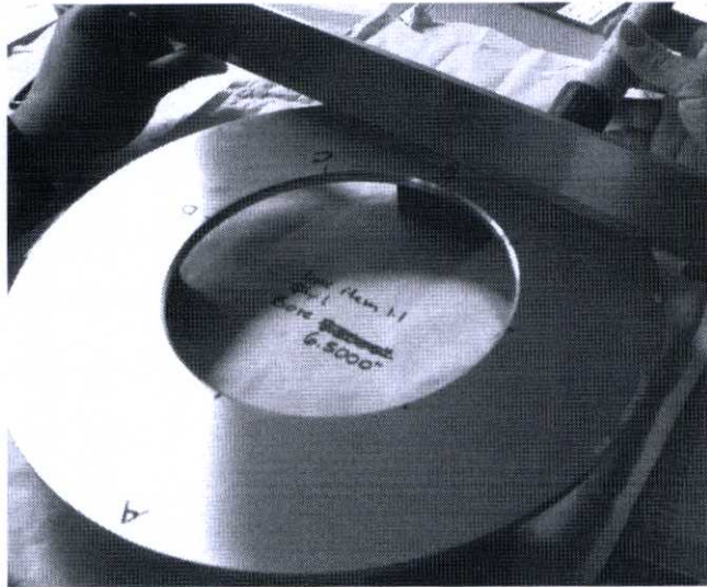
รูปที่ 1.1 วิธีการวัดความราบเรียบแผ่นออร์ฟิตแบบปัจจุบัน
