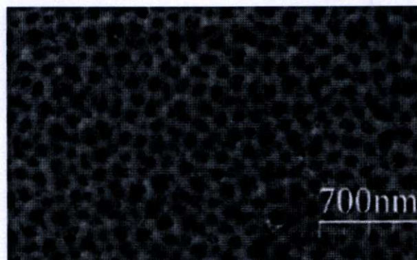
รูปที่ 2.40 การอโนไดซ์ด้วยกรดโครมิก [12]
