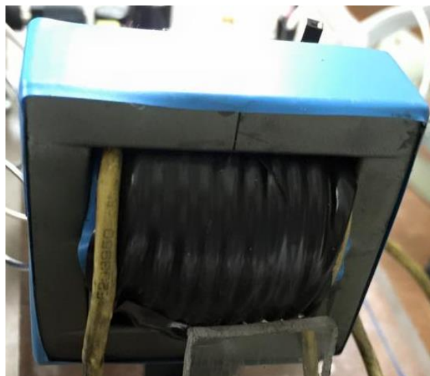
รูปที่ 3.8 หม้อแปลงความถี่สูงที่ใช้งานจริง
