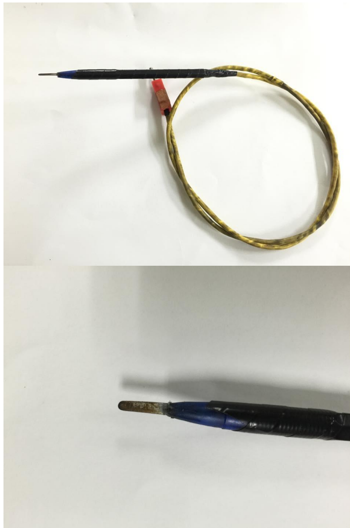
รูปที่ 3.16 อิเล็กโทรดแบบที่เปลี่ยนเป็นใบมีดที่ใช้งาน
