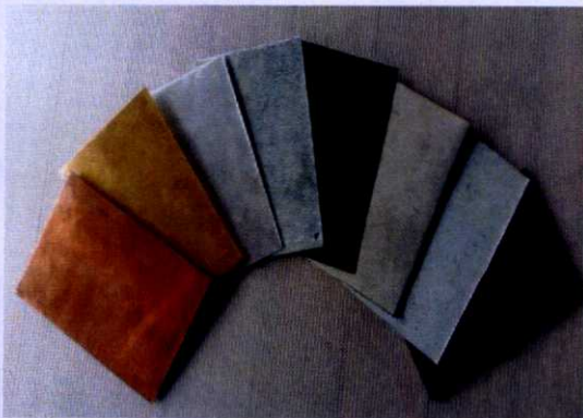
รูปที่ 6 แผ่นโลหะ 8 ชนิดที่นำมาใช้ในการทดสอบได้แก่ ทองแดง ทองเหลือง อะลูมิเนียม เหล็กชุบกัลวาไนส์ อะลูมิเนียมขัดเงา สแตนเลส เหล็กชิทไฟล์และเหล็ก
