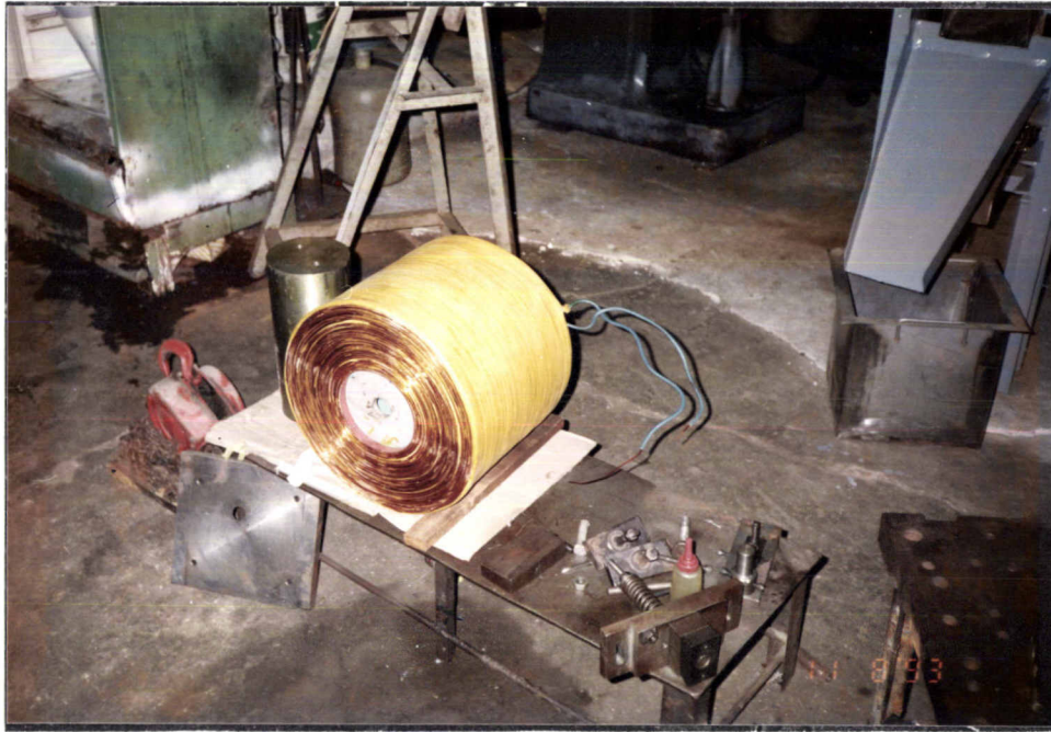
รูปที่ 5.14 ขดลวดเมื่อสำเร็จเรียบร้อยแล้ว
