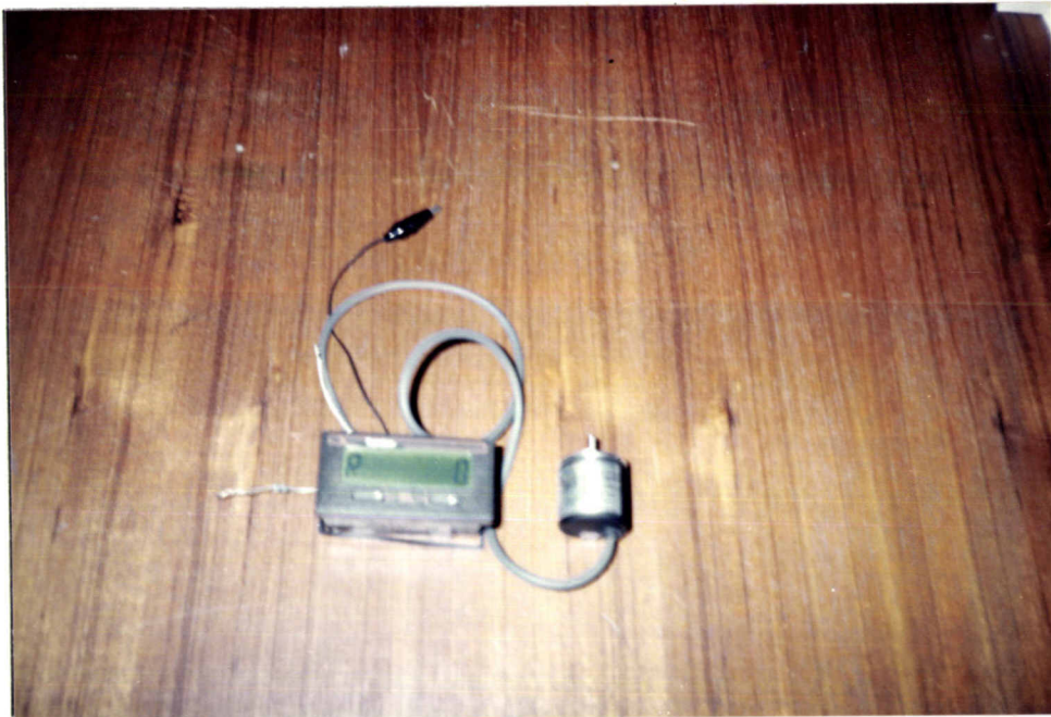
รูปที่ 5.17 แสดงตัวตรวจจับเพื่อบอกจำนวนรอบของ Roller
