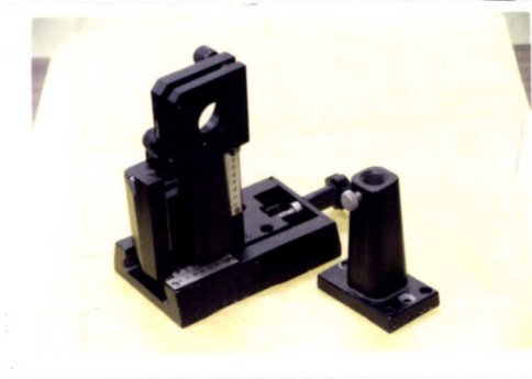
รูปที่ 5.3 แสดงอุปกรณ์ติดตั้งเลเซอร์ไดโอด
