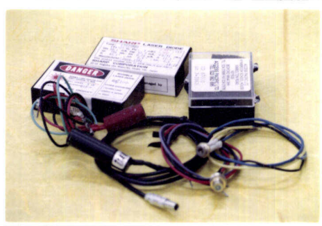
รูปที่ 5.2 แสดงเลเซอร์ไดโอด
