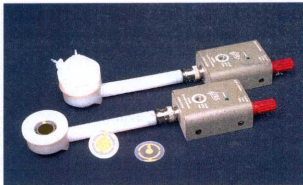
รูปที่ 2.7 หัววัดของเครื่องวัดมวลทางชีวภาพ
