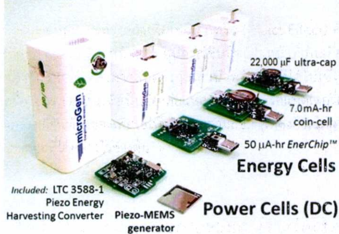
รูปที่ 2.13 อุปกรณ์เก็บพลังงานจากการสั่น MicroGen
