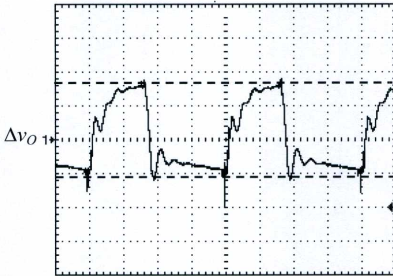
รูปที่ 4.4 รีปเปิ้ลแรงดันเอาต์พุต (ก) ที่กระแสโหลด 0.3A (ข) ที่กระแสโหลด 0.9A
