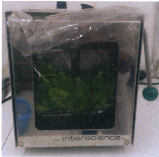
ภาพที่ 3.8 การทำบับกให้เป็นเนื้อเดียวกันด้วยเครื่อง Stomacher blender
