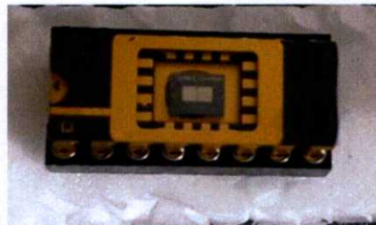
รูปที่ 3.7 ชิ้นงานที่ผ่านการตัดแยกชิ้นแล้วนำมาเชื่อมต่อขา
