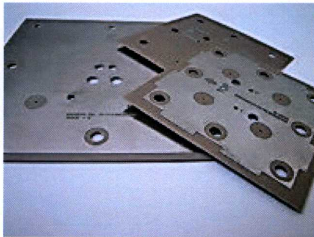
รูปที่ 2.6 แผงวงจรสำหรับกล่องทวนสัญญาณในไมโครเวฟ
