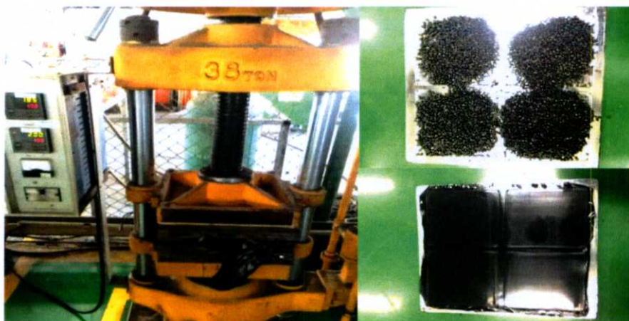
รูปที่ 3.4 การขึ้นรูปพลาสติกด้วยวิธีการอัดเข้าแม่พิมพ์(compression molding) ด้วยความร้อน
