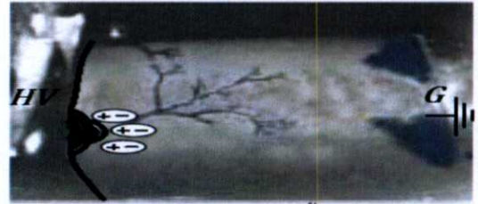
(ข) ความเครียดสนามไฟฟ้าสูงๆนั้นจะทำให้อากาศรอบๆ เกิดการแตกตัวไอออน (ionizes) การดิสชาร์จ (discharge) อาจเกิดขึ้นในบริเวณนี้
