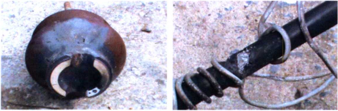
รูปที่ 1.4 ความล้มเหลวเนื่องจากการเกิดรอยทางผิวที่บริเวณผิวสาย SAC กับลูกถ้วยฉนวนไฟฟ้า
