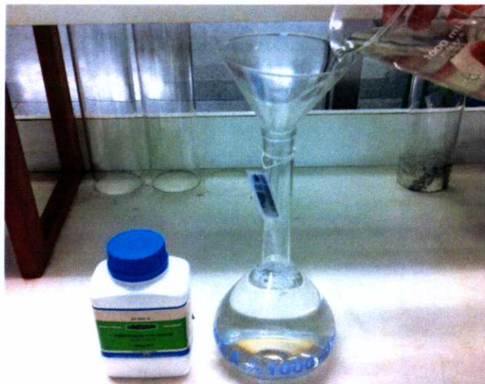
รูปที่ 3.16 สารแอมโมเนียมคลอไรด์( \text{NH}_4\text{Cl} ) 1 กรัม ผสมกับน้ำที่ปราศจากไอออน 1,000 ลูกบาศก์เซนติเมตร
