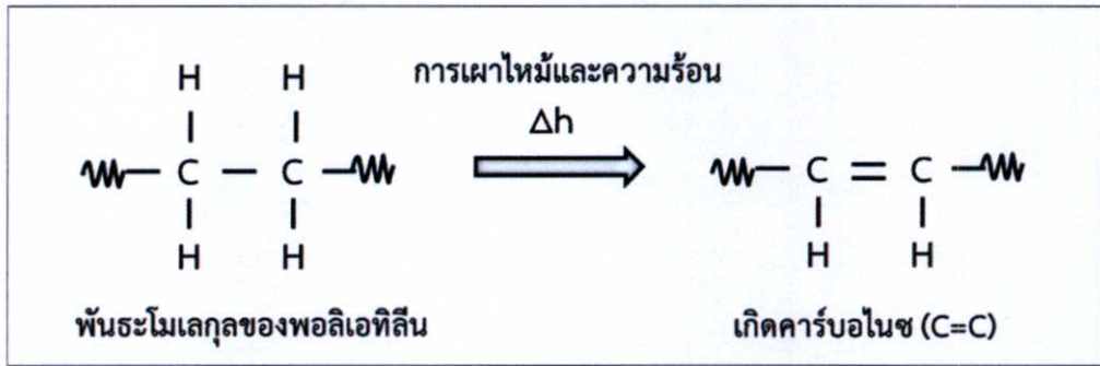
รูปที่ 2.29 การเกิดคาร์บอนไซของฉนวนพอลิเอทิลีน
