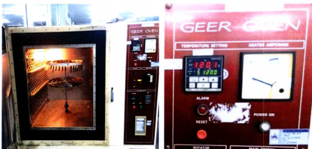
รูปที่ 3.7 ชิ้นตัวอย่างที่ถูกเร่งอายุด้วยความร้อน โดยการอบที่อุณหภูมิ 120^{\circ}\text{C} เป็นเวลา 168 ชั่วโมง
