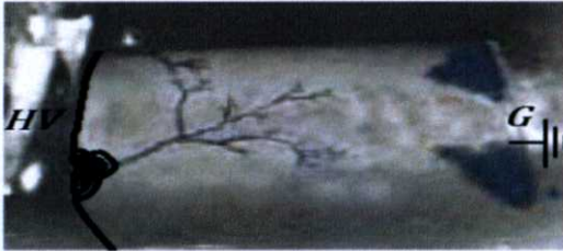
(ก) เกิดความเครียดสนามไฟฟ้าสูงที่บริเวณผิวของฉนวน บริเวณรอยต่อหรือจุดสัมผัส
