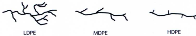
รูปที่ 2.33 ลักษณะโครงสร้างของพอลิเอทิลีนแต่ละชนิด
