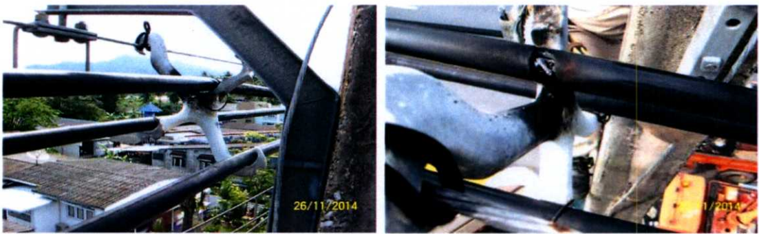
รูปที่ 1.5 ความล้มเหลวเนื่องจากการเกิดรอยทางผิวที่บริเวณผิวสาย SAC กับเคเบิลสเปเซอร์
