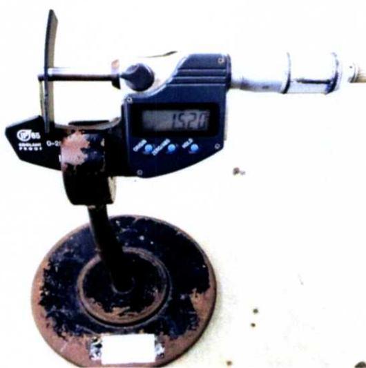
รูปที่ 3.6 การวัดความหนาชิ้นตัวอย่างทดสอบ ด้วยไมโครมิเตอร์
