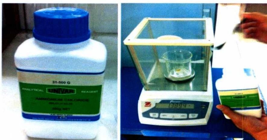
รูปที่ 3.15 การเตรียมสารแอมโมเนียมคลอไรด์( \text{NH}_4\text{Cl} ) โดยการชั่งน้ำหนักปริมาณ 1 กรัม
