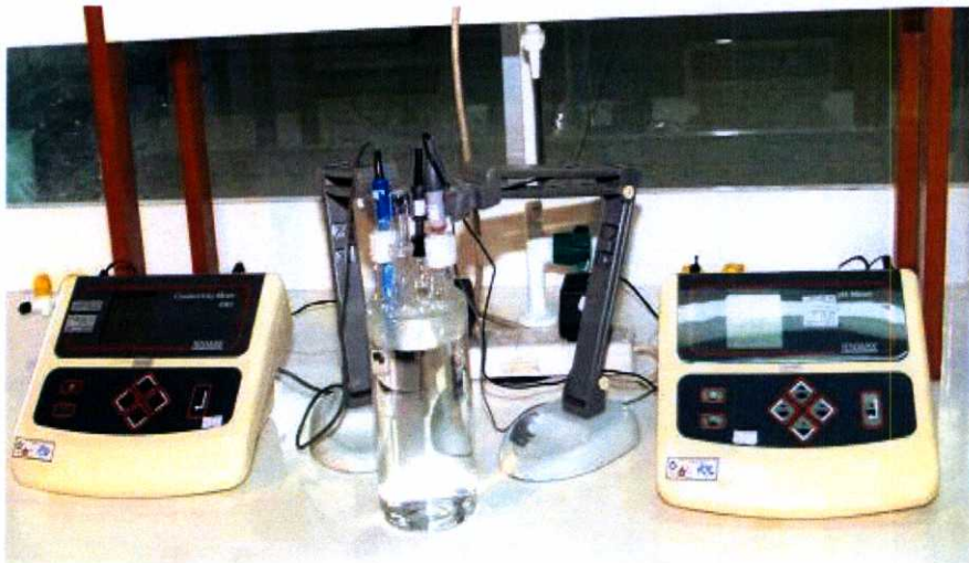
รูปที่ 3.22 การวัดค่า pH และค่าความนำไฟฟ้า ของสารละลายแอมโมเนียมคลอไรด์( \text{NH}_4\text{Cl} ) ความเข้มข้นร้อยละ 0.1
