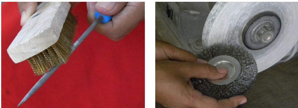
ภาพที่ 2.67 แปรงลวดเหล็กแบบต่างๆ และภาพแสดงการใช้งาน ที่มา : (กรมศิลปกร. 2553 : 33)
