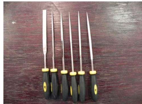
ภาพที่ 2.51 ตะไบทางหนู ตะไบเพชร ที่มา : (กรมศิลปกร. 2553 : 26)
