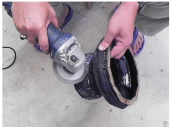
ภาพที่ 2.65 ลูกหมุน และภาพแสดงการใช้งาน ที่มา : (กรมศิลปกร. 2553 : 32)
