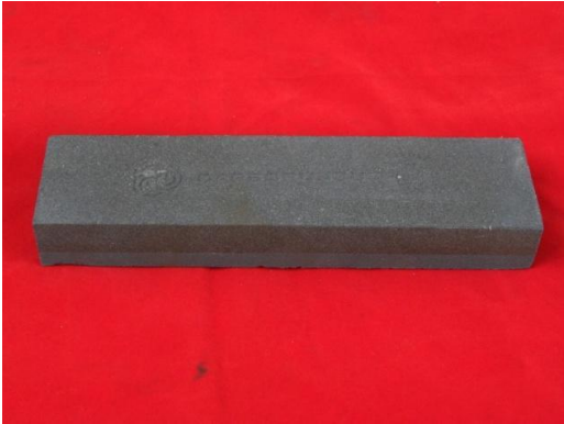
ภาพที่ 2.64 หินกากเพชร/หินลับมีด และภาพแสดงการใช้งาน ที่มา : (กรมศิลปกร. 2553 : 31)
