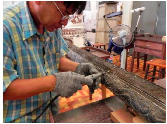
ภาพที่ 2.62 แสดงการใช้สว่านแบบ และขนาดต่างๆ ที่มา : (กรมศิลปกร. 2553 : 30)
