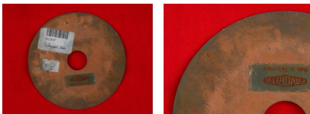
ภาพที่ 2.39 ใบตัดพลอยสีทองแดง ที่มา : (กรมศิลปกร. 2553 : 20)
