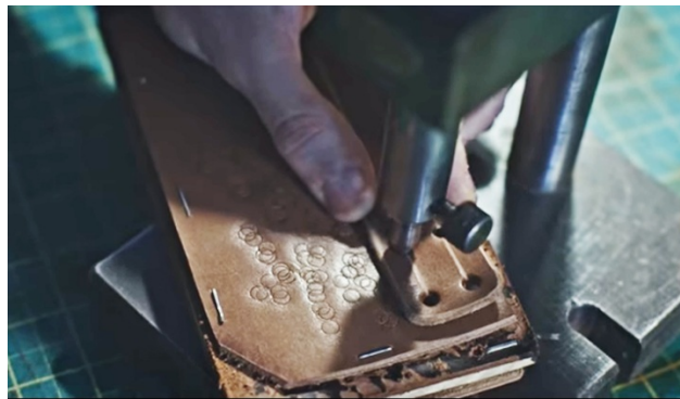
ภาพที่ 2.70 ภาพการเจาะรูตะเข็บ ที่มา : http://www.youtube.com/watch?v=IIMrKR6W6d8 , 2560. [ออนไลน์]
