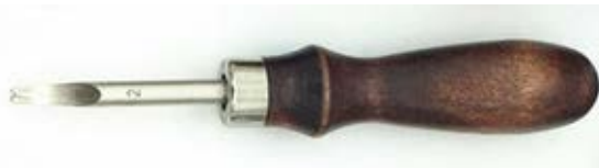
ภาพที่ 2.52 เครื่องมือทำลวดลายเป็นจุด (Stippler)
