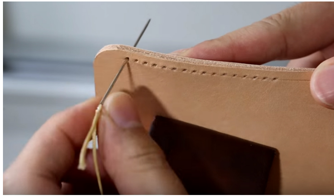
ภาพที่ 2.69 ภาพการใช้เข็มเย็บอานม้า และเหล็กแหลม ที่มา : http://www.youtube.com/watch?v=IIMrKR6W6d8 , 2560. [ออนไลน์]
