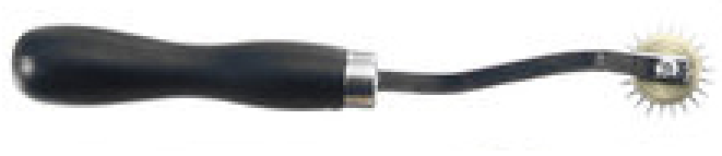
ภาพที่ 2.81 ภาพลูกกลิ้งกระยะช่องไฟเพื่อเจาะรู
