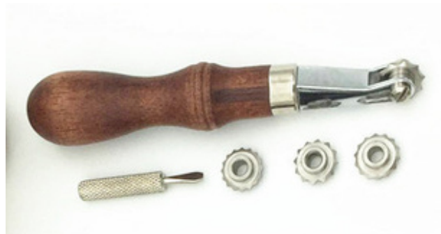
ภาพที่ 2.50 ลูกกลิ้งทำรอยจุดช่องไฟ (Space Marker)
