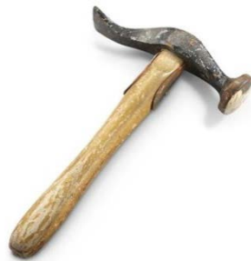
ภาพที่ 2.24 ค้อนเหล็ก (Cobbler's Hammer)
