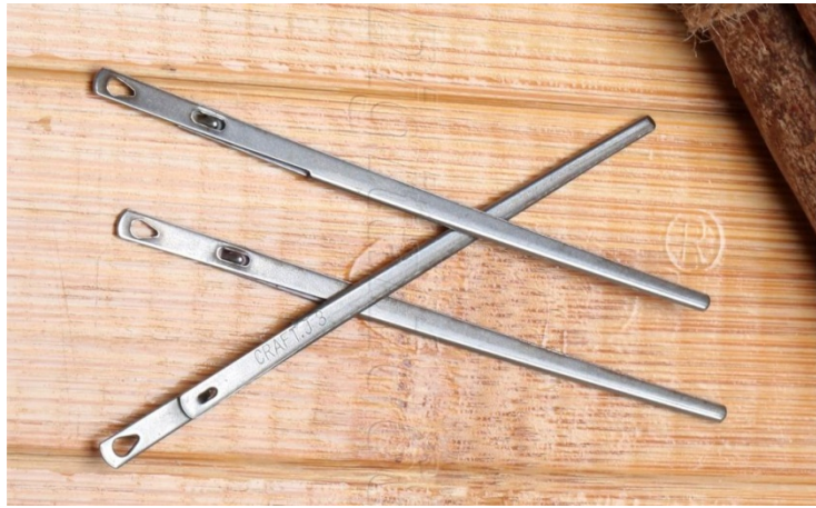
ภาพที่ 2.39 เข็มถักกริม (Needle, Lacing)
