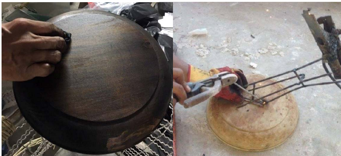
ภาพที่ 4.18 เตรียมฐานไม้รอง และเชื่อมโครงเหล็ก ที่มา : ชูติพงศ์ พรหมดี (2560)
