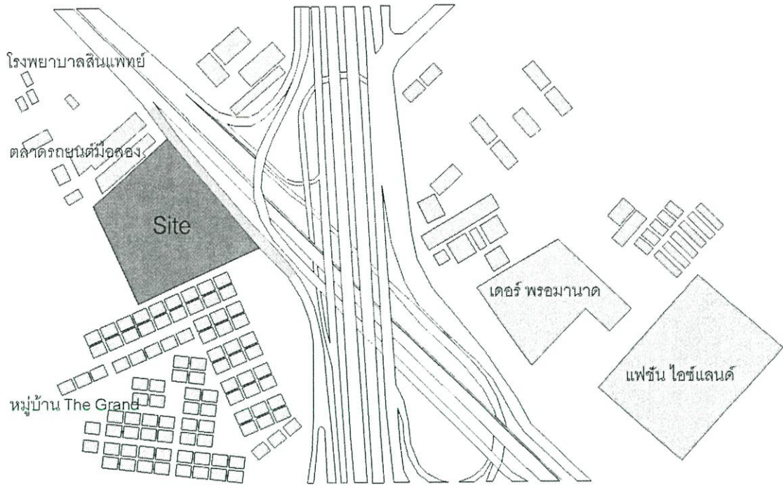
รูปที่ 6-7 แสดงความกว้างถนนหน้าโครงการ ถนนหน้าโครงการเป็นถนน 4 เลน ความกว้างรวมประมาณ 12 ม.
