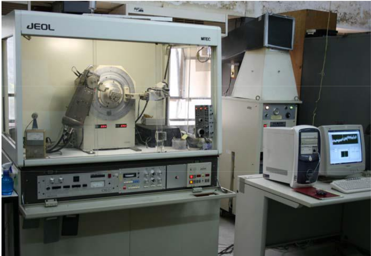
ภาพที่ 3.1 เครื่องเอ็กซ์เรย์ดิฟแฟรคโตมิเตอร์ (X-ray diffractometer)
