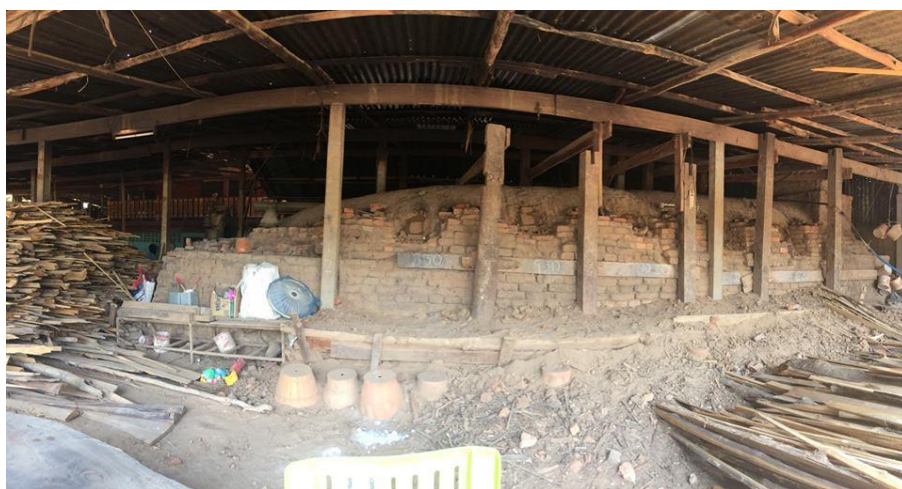
ภาพที่ ง.11 เตาทางเดินลมร้อนแบบขนาน (Horizontal draft kiln) ภาพโดย : รัชณี ลีอดารา 28 พฤษภาคม 2560
