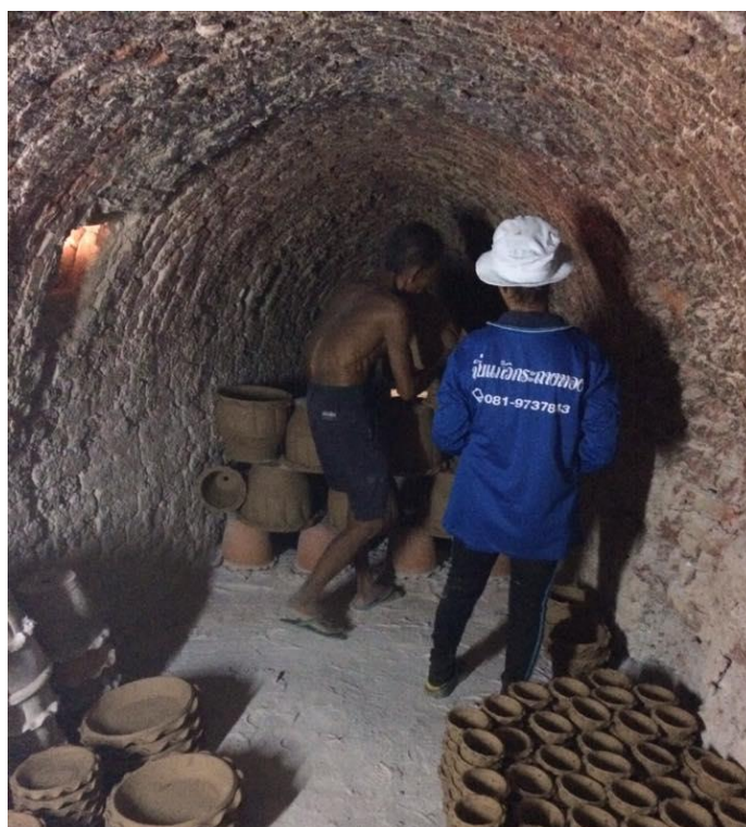
ภาพที่ ง.10 การเรียงผลิตภัณฑ์เข้าเตาเผา ภาพโดย : รัชณี ลือดารา 28 พฤษภาคม 2560
