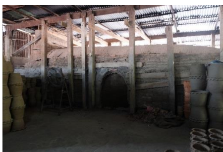
ภาพที่ 2.47 เตาเผาแบบทางเดินลมร้อนขนาน (Horizontal Draft Kiln) ภาพโดย : รัชณี ลือดารา 28 พฤษภาคม 2560
