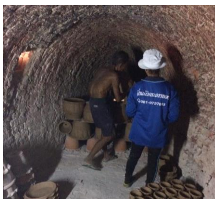
ภาพที่ 2.45 การเรียงผลิตภัณฑ์ในเตาเผาแบบทางเดินลมร้อนขนาน (Horizontal Draft Kiln) ภาพโดย : รัชณี ลือดารา 28 พฤษภาคม 2560
