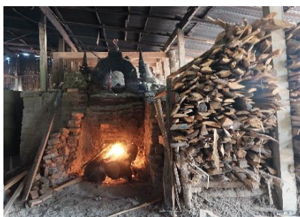
ภาพที่ 2.46 เชื้อเพลิงที่ใช้ในการเผาผลิตภัณฑ์ ภาพโดย : รัชณี ลือดารา 28 พฤษภาคม 2560
