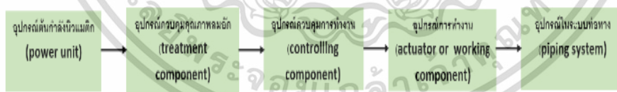
ภาพที่ 2.106 หลักการทํางาน Pneumatics Control ที่มา : www.factomart. [ออนไลน์] (2559)
