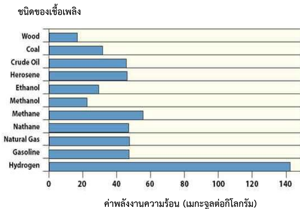
รูปที่ 2.1 ค่าพลังงานความร้อนของเชื้อเพลิงชนิดต่างๆ
