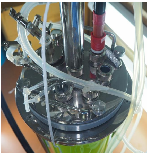
รูปที่ ค 2 บริเวณฝาปิดด้านบน (Upper head plate) ที่มีช่อง (ports) สำหรับใส่หัววัดต่างๆ
