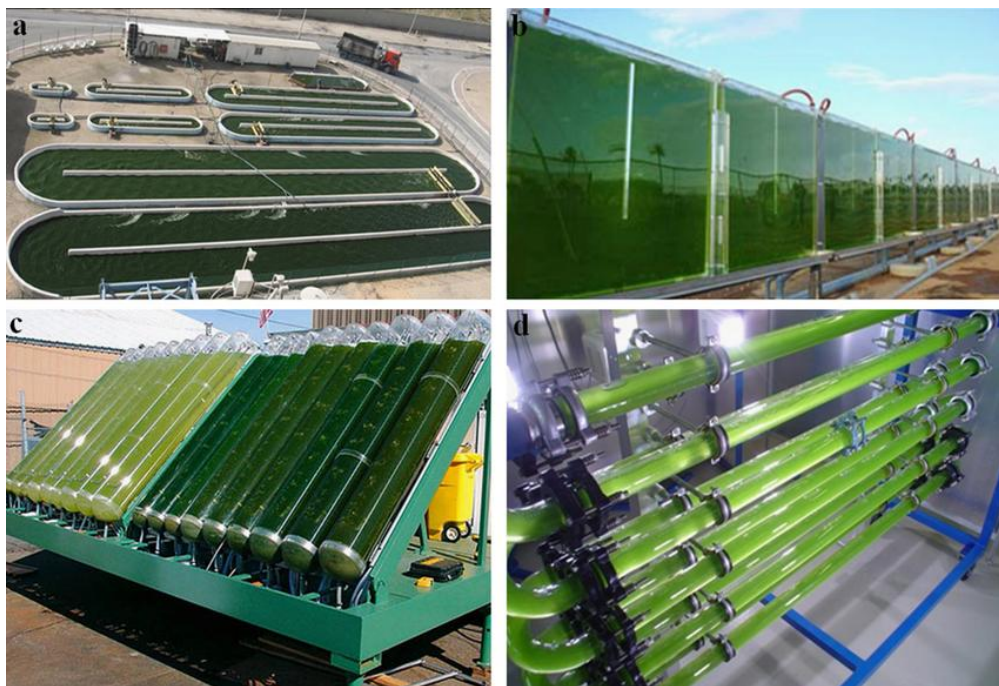
รูปที่ 2.10 ตัวอย่างการเพาะเลี้ยงสาหร่ายสีเขียวในระบบเปิดและระบบปิด (Raceway pond (a), Flat-plate type (b), Inclined tubular type (c) และ Horizontal/Continuous type (d))
