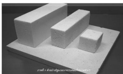
ภาพที่ 2.37 แสดงลักษณะตัวอย่างที่ใช้โดโลไมต์เป็นสารก่อฟองโฟมกลาส ที่มา : วารสารกรมวิทยาศาสตร์บริการ : 2558
