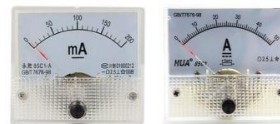
ภาพที่ 1.1 ตัวอย่างมีทั้งแอมมิเตอร์และแอมมิเตอร์ไฟฟ้ากระแสตรง
