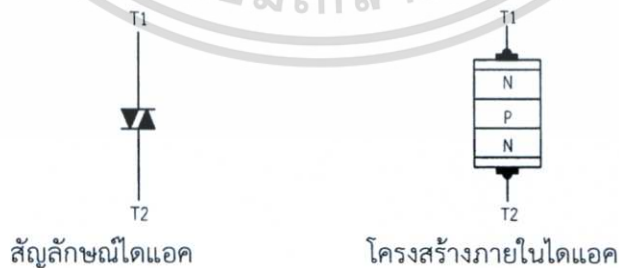
รูปที่ 1 แสดงสัญลักษณ์และโครงสร้างของไดโอด
