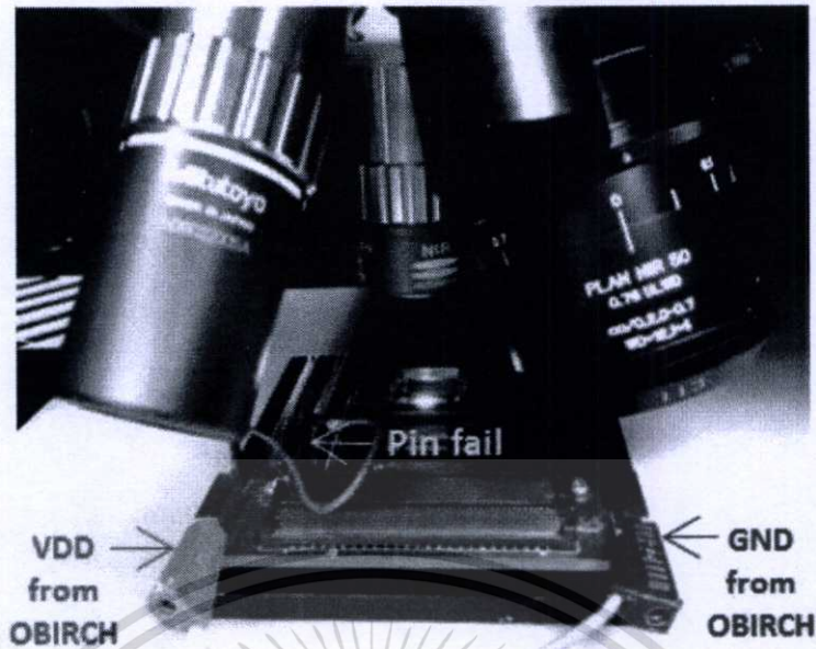
ภาพที่ 3.4 การติดตั้งและใช้เทคนิคโออาร์-โอเบิร์ช
