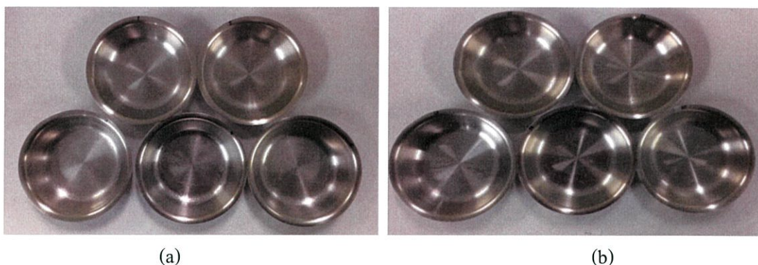
รูปที่ 4.21 ลักษณะ overall migration จากถุงมือยางไนไตรล์สังเคราะห์แบบบางในกรดอะซิติก 3% ที่อุณหภูมิ 40 °C (a) และ 55 °C (b)
