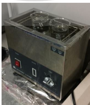
รูปที่ 3.12 การทำความสะอาดกระจกสไลด์โดยใช้อ่างล้างด้วยคลื่นอัลตราโซนิก
