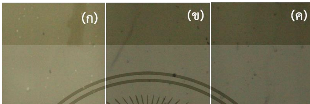
รูปที่ 4.4 ลักษณะของฟิล์มบางเลด (II) ซัลไฟด์ที่สังเคราะห์ลงบนชั้นไทเทเนียมไดออกไซด์โครงสร้างนาโนภายใต้เงื่อนไขจำนวนรอบในการจุ่มสารละลายไอออนเดียวกันคือ 3 รอบ โดยมีความเข้มข้นของสารละลายตั้งต้นที่แตกต่างกัน ได้แก่ (ก) 0.01 M (ข) 0.03 M และ (ค) 0.05 M ตามลำดับ
