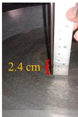
รูปที่ 4.1 ระยะการจุ่มหัววัดอุณหภูมิ
