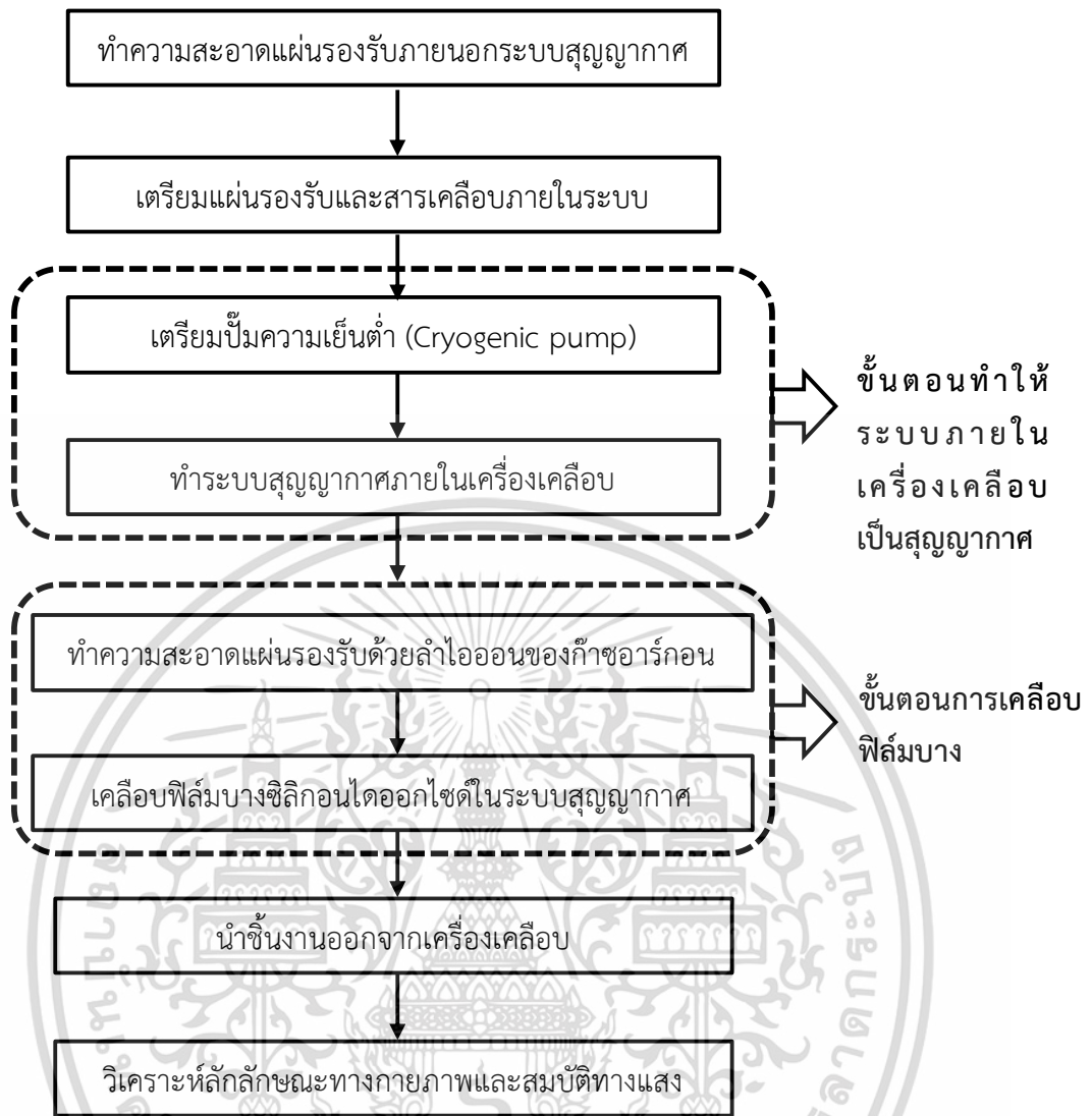
รูปที่ 3.5 แผนภาพการเตรียมชั้นฟิล์มบางซิลิกอนไดออกไซด์โดยกระบวนการเคลือบแบบระเหยสารด้วยลำอิเล็กตรอนร่วมกับเทคนิคการเคลือบแบบ OAD และ GLAD ภายใต้ระบบสุญญากาศ
