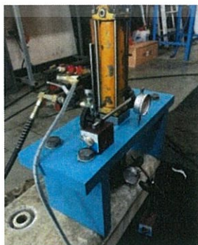
รูปที่ 3.31 แสดงการติดตั้งชุดทดสอบแรงถอนวัตถุฝังยัด
