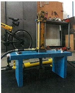
รูปที่ 3.29 แสดงชุดทดลองในการทดสอบแรงถอนวัตถุฝังยัด
