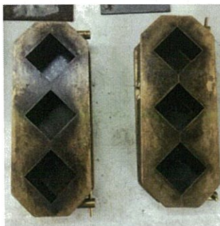
รูปที่ 3.2 แบบหล่อลูกบาศก์ขนาด 5x5x5 เซนติเมตร
