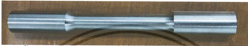
รูปที่ 3.2 แบบชิ้นงานสำหรับใช้ทดสอบแรงดึงตามมาตรฐาน ASTM Standards E8/E8M – 09
