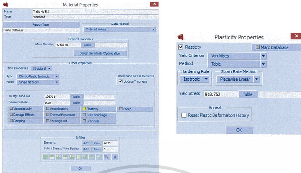
รูปที่ 3.7 แสดงค่า Material properties ของชิ้นงาน Ti-6Al-4V ELI
