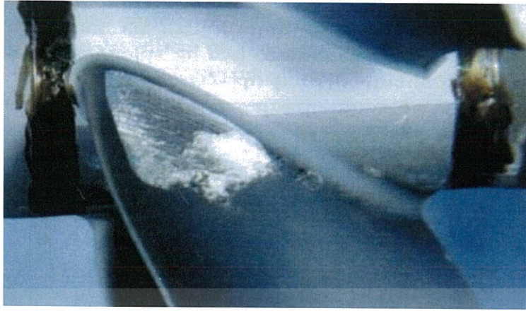
รูปที่ 2.7 แสดงความเสียหายของ kaplan turbine ที่เกิดจากควิเทชั่น
