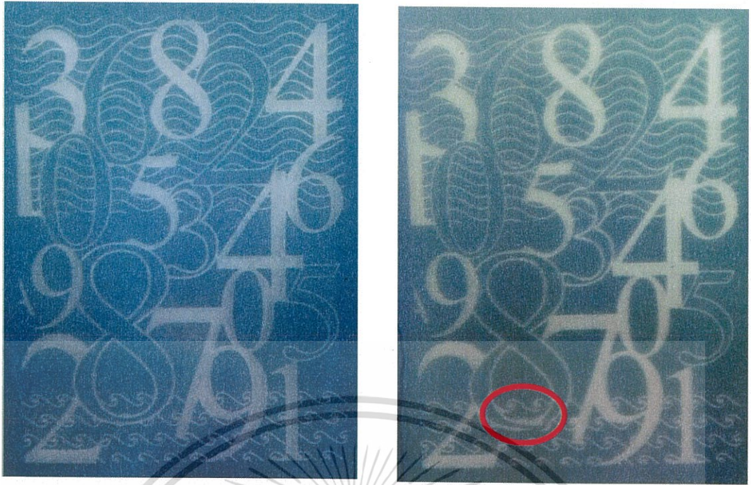
(ค) फिल्मกาวอัดสูตร PO4T6L4B ที่เก็บไว้ 7 วัน (ซ้าย) และ 45 วัน (ขวา)
