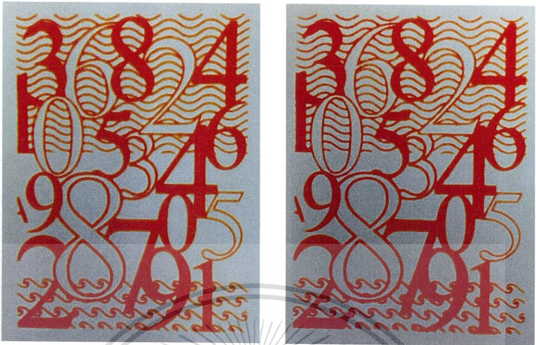
(ค) फिल्मการอัดสูตร PO4T6L4B ที่เก็บไว้ 7 วัน (ง) फिल्मการอัดสูตร PO4T6L3C1B ที่เก็บไว้ 7 วัน รูปที่ 4.16 ลายภาพที่ได้จากการสกรีนโดยใช้หมึกพิมพ์เชื่อน้ำ จาก फिल्मการอัดสูตรต่าง ๆ (ต่อ)
